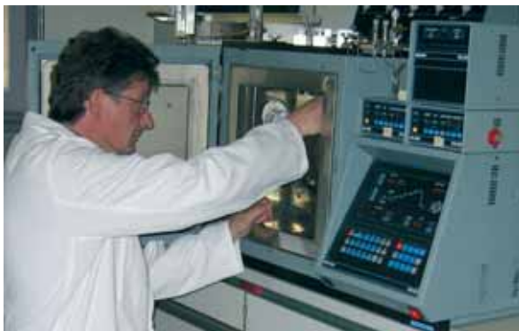
Im Labor wird der Gaschromatograph für die Bestimmung unzulässiger Zusätze von Pfirsicharoma vorbereitet.
