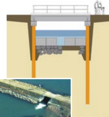
*Ein innovatives, flexibles Zulaufbauwerk wurde errichtet, das auch bei niedrigsten Rheinwasserständen den Frischwasserzufluss in den Altrhein sichert.*
