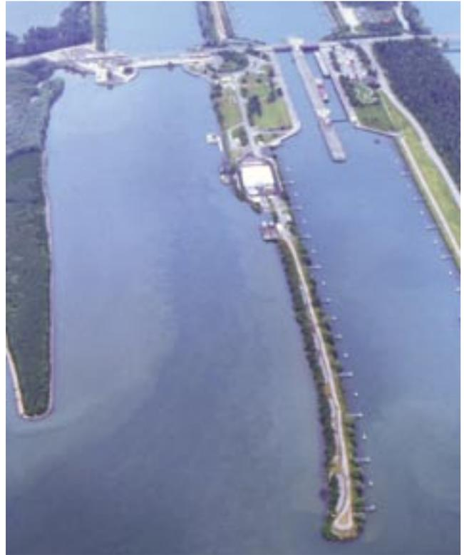
*Die Staustufen am Oberrhein sind Absetzbecken für Schwebstoffe, Wasserfahnen deuten dies an.*
