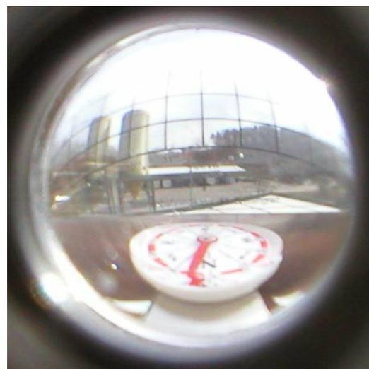
Abbildung 2-2: Sonnenbahnindikator (links) und Blick durch den Sonnenbahnindikator (rechts)
