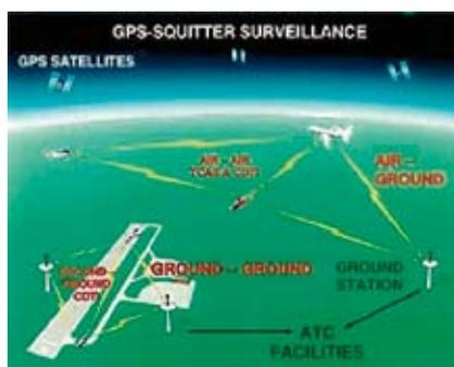
Da die Funktionalität von ADS-B 1090 ES nicht auf fliegende Systeme beschränkt ist, lässt sich mit verhältnismäßig einfachen und preiswerten Mitteln eine Positionsbestimmung von Flughafenfahrzeugen und rollenden Luftfahrzeugen auf dem Vorfeld realisieren. Eine solche Lösung ist besonders für kleinere Regionalflughäfen, die über kein eigenes Vorfeldradar verfügen, interessant.
