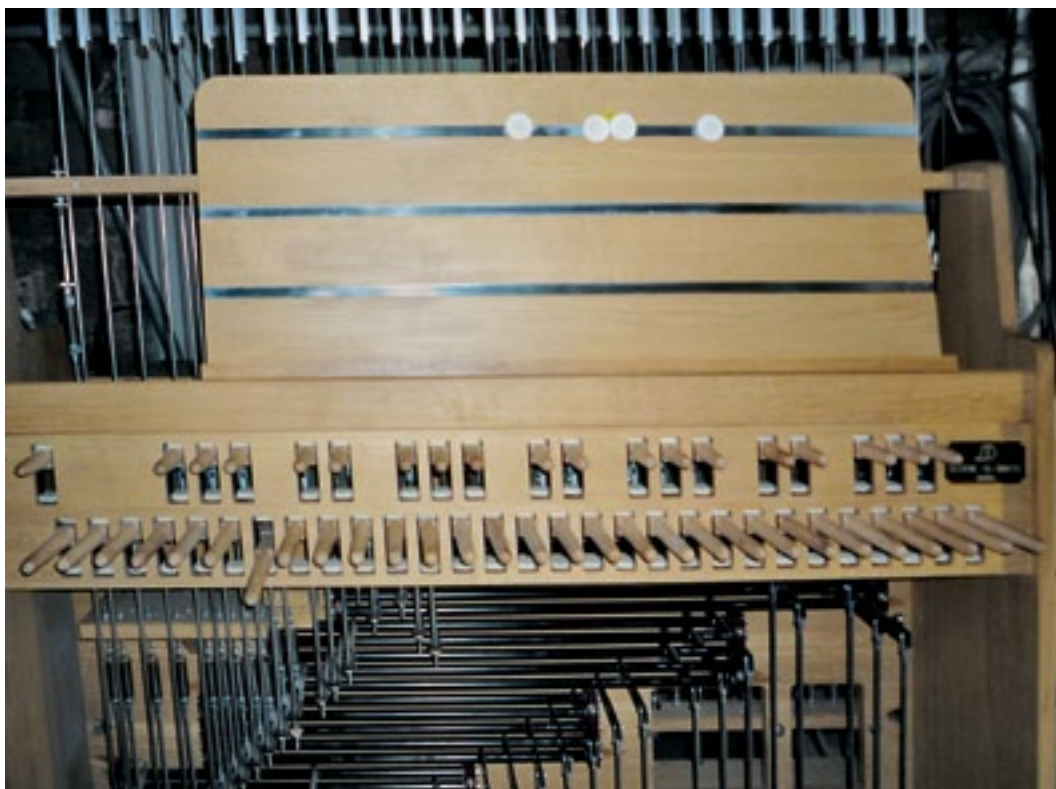
Das Stockenklavier des Carillons mit sichtbaren Drahtzügen
