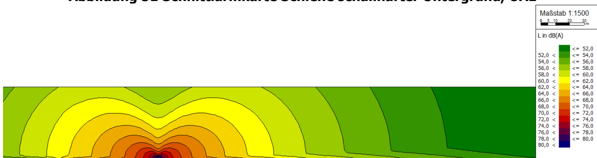
Abbildung 51 Schnittlärmkarte Schiene schallharter Untergrund, ÖAL
