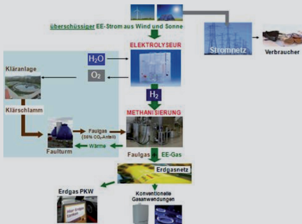
Abb. 11: Prinzipschema Kläranlage mit „Power-to-Gas“
