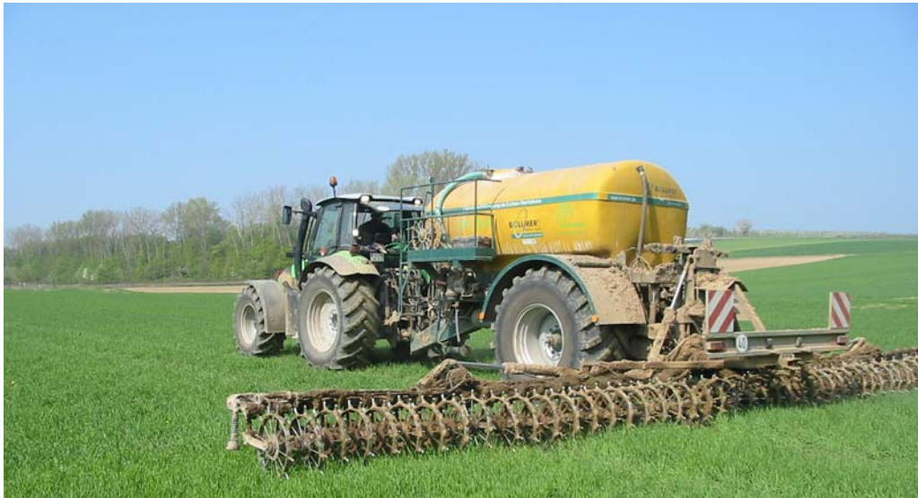
Abbildung 9-2: Igelrad-Injektionstechnik, Bild: Richter 2010
