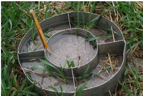
Abbildung 7-5: Messung der Wasseraufnahmefähigkeit an der Bodenoberfläche mit Doppelringinfiltrometern am Standort Welschbillig
