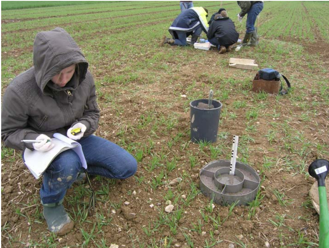
Abbildung 5-1: Studierende der FH Bingen bei der Messung der Wasserinfiltration mit dem Doppelring-Infiltrimeter auf dem Standort Dichtelbach im Hunsrück
