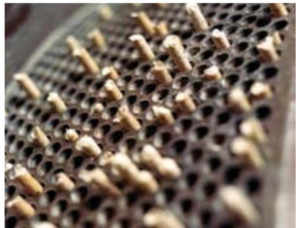
Bild rechts: Matrice zur Herstellung von Holzpellets
