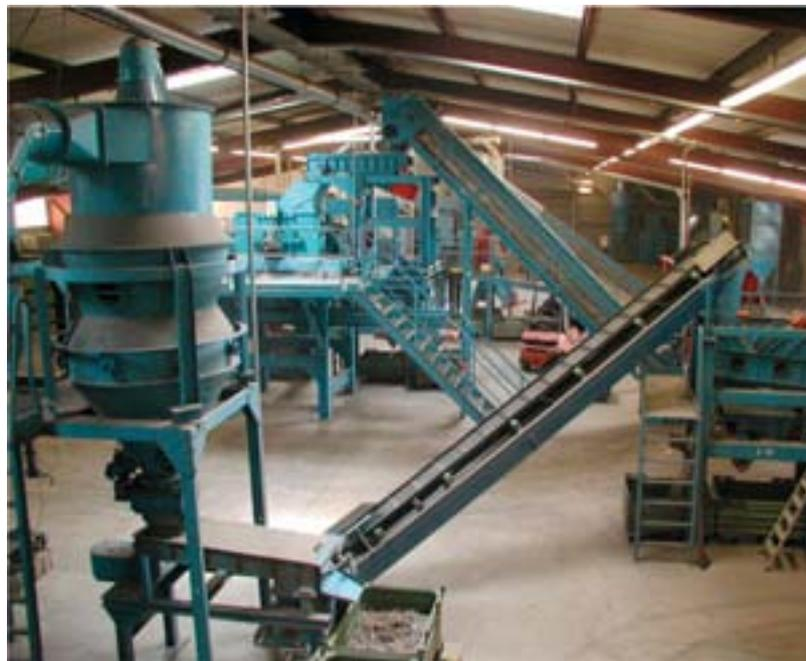
Trockenmechanische Aufbereitungsanlage für E-Schrott bei der Firma ALBA R-Plus GmbH in Lustadt
