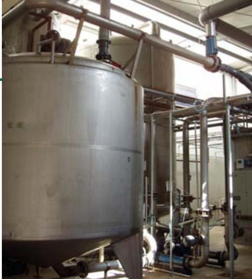
Hygienisierungsstufe der ZEUS-Biogasanlage in Reinsfeld
