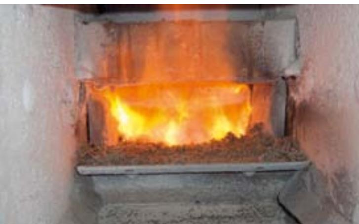
Abbrandversuch mit Tresterpellets
