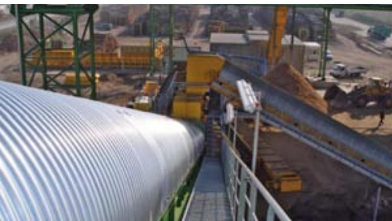
Bild oben: Brennstoffzuführung mit Überlängenabscheidung für das Biomasseheizkraftwerk Eberswald
