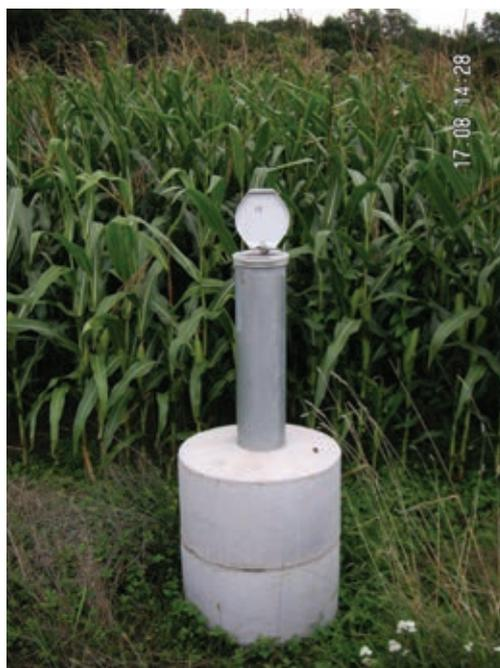
Abb. 71: Grundwassermessstelle
