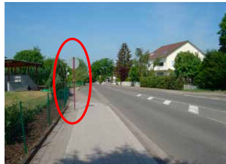
Rodenbach: Beginn / Ende des Straßenbegleitenden Radweges => Bordsteinabsenkung zum Fahrbahnwechsel ist nicht optimal und das VZ 240 sowie das Zusatzzeichen „Radweg Ende“ fehlen
