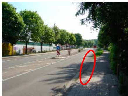
Rodenbach: Vorschlag den Beginn / das Ende des Radweges an diese Stelle zu setzen => Nullabsenkung vorhanden und der Radweg ist weg aus der Busbucht
