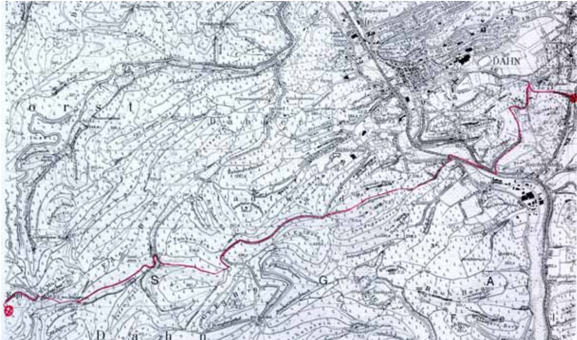
Abbildung 4: Möglicher Verlauf des 20kV-Erdkabels zur Netzverstärkung
