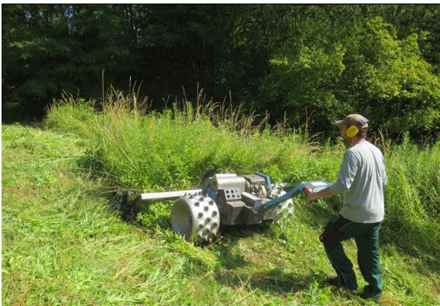
Die kleinflächig wechselnden Standortbedingungen der ehemaligen Tongrube erfordern eine kleinflächig differenzierte Mahd. Wegen Bodenunebenheiten, Feuchtstellen und eingestreuten Gehölzen ist oft nur eine Mahd mit Hand-Balkenmäher möglich.
