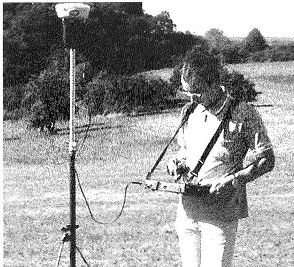
*Bild 1: GPS-Messung mit dem Rover Trimble 5800 und einem Feldrechner der Firma Mettenmeier*
