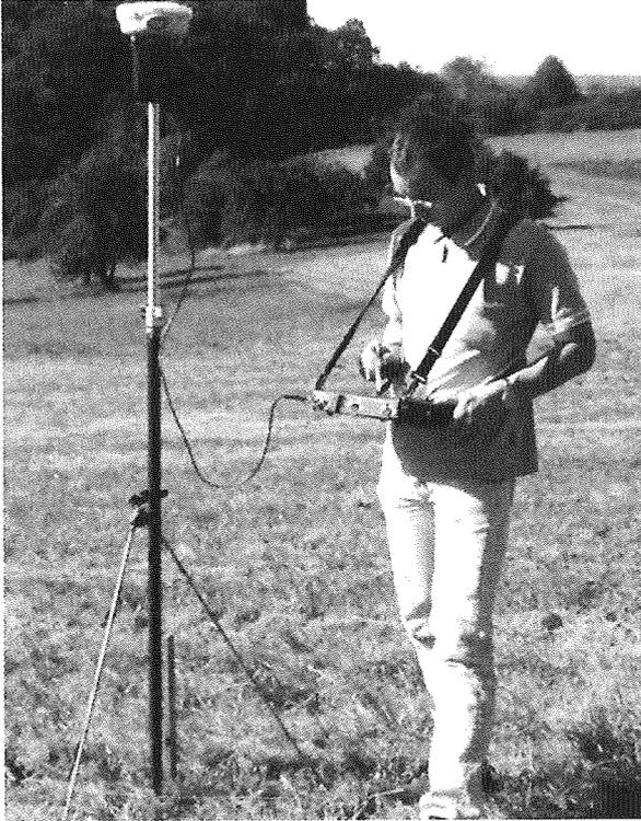
Abb. 2: Der Vermesser hat mit dem Feldrechner die vollständige Kontrolle über die angeschlossenen Messsysteme, die Abarbeitung der vermessungstechnischen Abläufe mit visueller Kontrolle in der Grafik sowie die Erfassung vieler Attribute vor Ort, wo sie auch entstehen.
