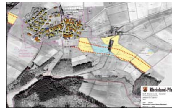
Abb. 2: Sicherstellung des 60 m breiten Limeskorridores mit Hilfe der Bodenordnung im Verfahrensgebiet (gelb- Gemeinde, blau-TG später Gemeinde, rot – Korridor)
