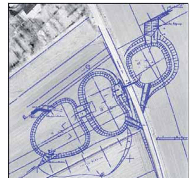
Abb. 11: Planung der Rückhaltebecken
