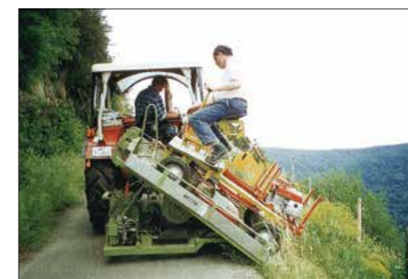
Abb. 1: Geräteträger mit Mulchgerät beim Umsetzen auf der Auffahrpritsche
