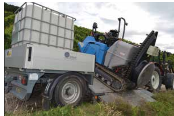
Abb. 3: RMS mit Raupe der Fa. Geier und Anhänger mit Kipp-, Ladepritsche
