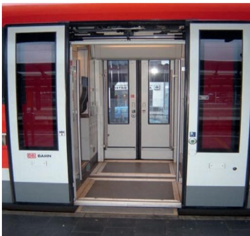
Ebenerdiger Zugang mit automatischer Spaltüberbrückung
