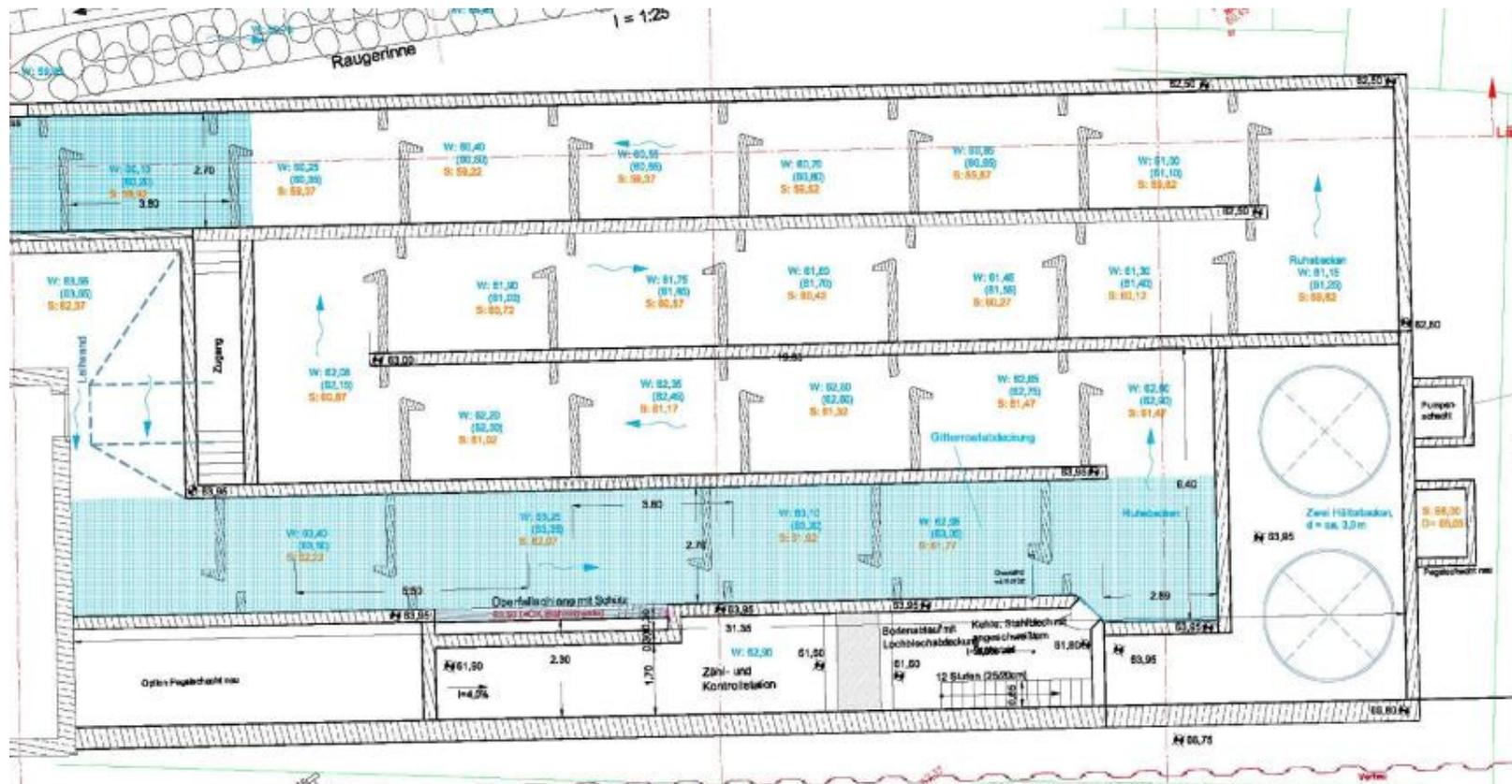
LAGEPLAN BECKENPASS MIT FANG- UND KONTROLLSTATION
