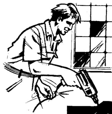
**Friedel** hat eine Praktikumsstelle in einem Handwerksbetrieb. Er darf mit einer Handbohrmaschine arbeiten. Als Friedel die Maschine benutzen will, merkt er, daß Stecker oder Kabel defekt sind. Die Maschine funktioniert nur, wenn man das Kabel direkt am Stecker in eine bestimmte Richtung hält.
