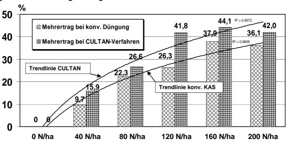
Der durchschnittliche relative Ertragsanstieg betrug im CULTAN-Verfahren 34 % gegenüber ungedüngt, im konventionellen Verfahren erreichte er 26 %. Die tendenziell bessere N-Ausnutzung bzw. Düngeeffizienz der Injektionsdüngung wird durch die Trendlinien abgebildet. Im Versuch konnte zum Beispiel durch Injektionsdüngung nach dem CULTAN-Verfahren in der Düngestufe 80 kg N/ha ein Knollenertrag erzielt werden, für den bei konventioneller Düngemethode 120 kg N/ha Zufuhr benötigt wurden.
