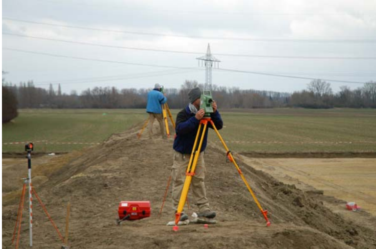
Abb. 6 Vermessungsarbeiten mit zwei Lasertachymetern während der Lehrgrabungskampagnen.
