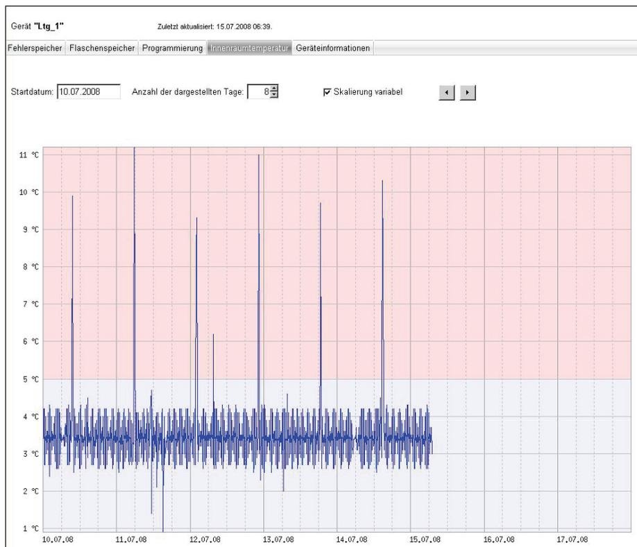
Abb. 9: Beispielhafter Verlauf der Innentemperatur des Probennehmers der Leitung 1
