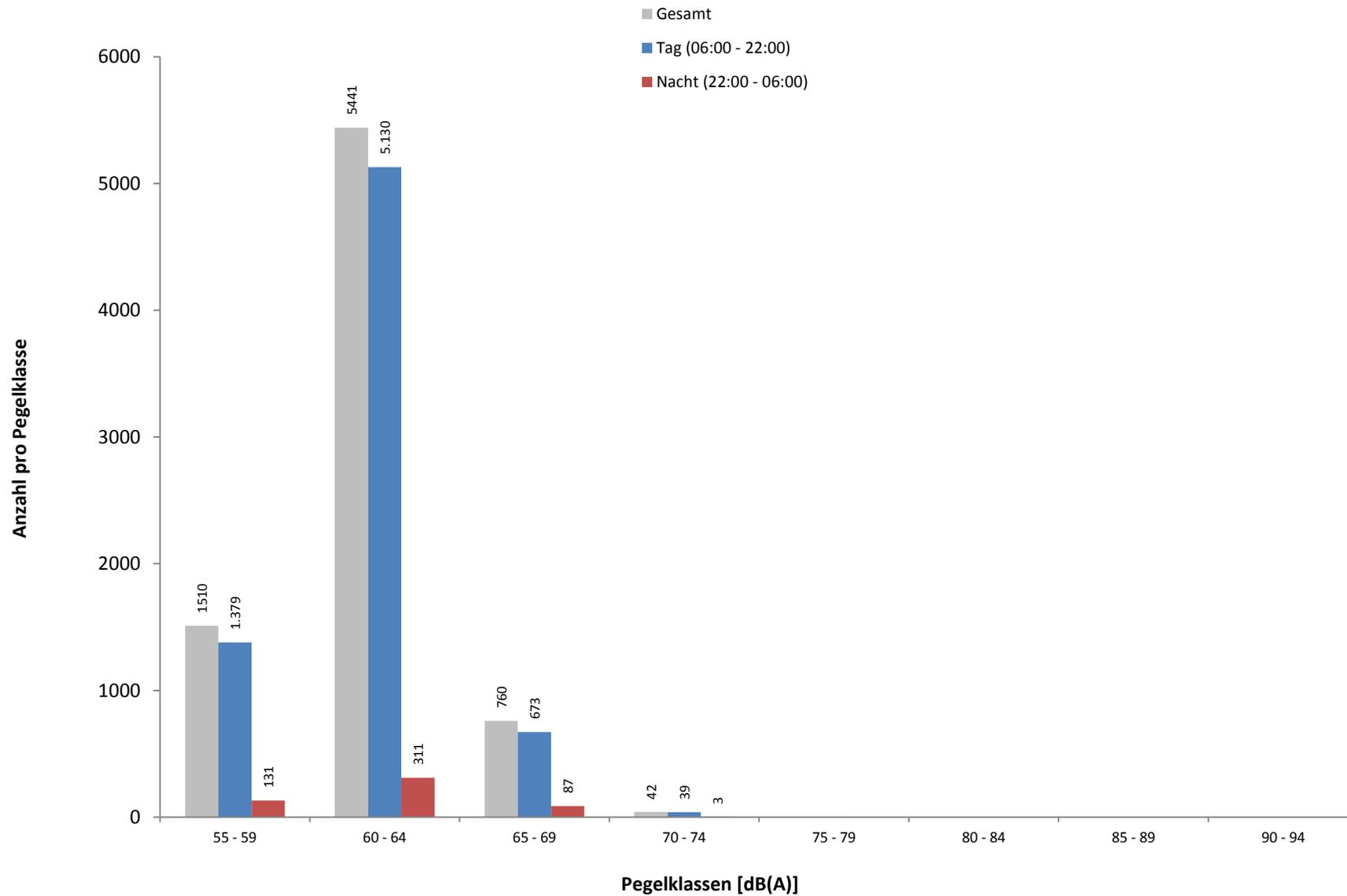
Häufigkeitsverteilung der Maximalpegel ( $L_{ASmax}$ ) in Pegelklassen mit 5 dB(A) Breite. Hierbei sei angemerkt, dass die erste Klasse nur Werte  $\geq 58$  dB(A) enthält.
