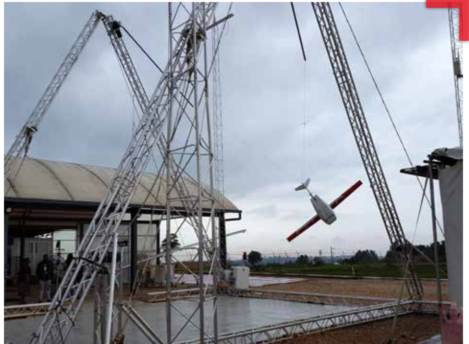
Der Drohnenbahnhof und die Abfanganlage.
