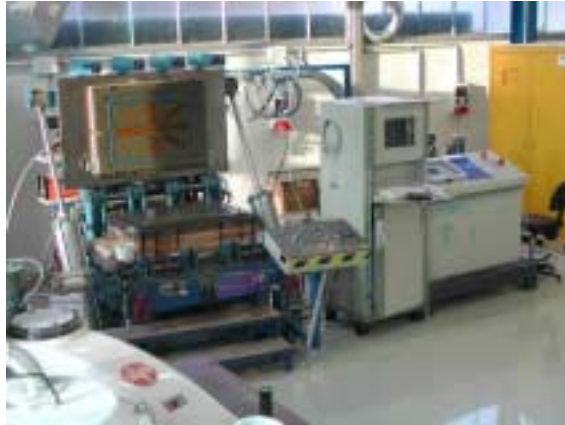
Bild 2: Injektionsanlage mit Steuerungsrechner sowie Werkzeugträger mit Permeameter
