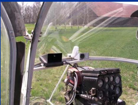
Pilot fliegt weitgehend nur nach Display, bearbeitete Flächen werden am Display angezeigt, Lücken und Überlappungen treten kaum mehr auf
