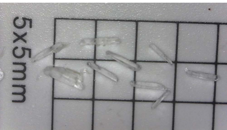
Laien könnten sie für Glassplitter halten: Struvitkristalle unter dem Mikroskop. © LUA
