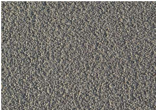
Abb. 8.7 – Oberflächentextur mit Reaktionsharz und Abstreuung
