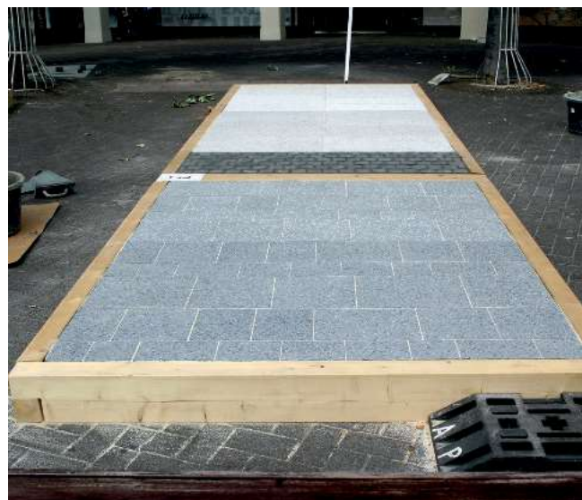
Abb. 4.5 – Musterflächen können bereits in der Planung auf ihre Eignung hinsichtlich der Barrierefreiheit in situ geprüft werden
