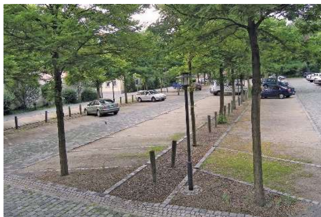
Abb. 7.12 – Beispiel einer baumüberstellten, zentralen Stellplatzanlage mit Schotterrasen in Bad Langensalza, hier Robinien
