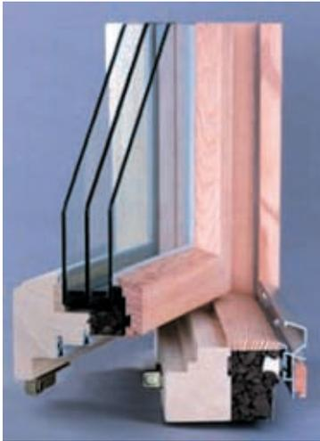
schließen. Die Art der Verglasung und der Rahmen bestimmen die Wärmeverluste. Am besten sind gedämmte Rahmen mit 3-facher Wärmeschutzverglasung. Wichtig beim Einbau ist die sachgerechte Abdichtung der Fenster. Um eine luftdichte Ebene zu erhalten, werden Folien, die am Fenster befestigt sind, an der Fensterlaibung verklebt.
