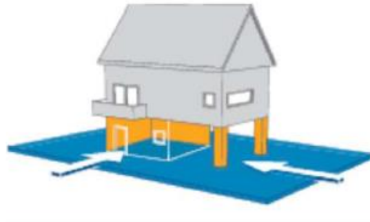
Abbildung 75: Ausweichen; Aufständigung (links); „Nasse Vorsorge“ (rechts); Quellen: Hochwasser-Risiko-bewusst planen und bauen, WBW Fortbildungsgesellschaft für Gewässerentwicklung, Februar 2015, S.29. & Wassersensibel planen und bauen in Köln, Leitfaden zur Starkregenvorsorge für Hauseigentümer, Bauwillige und Architekten, StEB Köln, S.16
