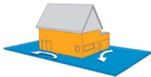
Abbildung 76: Widerstehen und Abschirmen – Mobile Wasserschutzwand (links), Abdichten des Gebäudes (rechts); Quellen: https://www.br.de/nachricht/inhalt/hochwasserschutz-bayern-114.html Wassersensibel planen und bauen in Köln, Leitfaden zur Starkregenvorsorge für Hauseigentümer, Bauwillige und Architekten, StEB Köln, S.16
